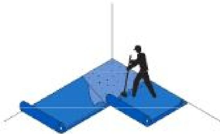
展开卷材，以黑色一面对着地面或墙面。端部搭接区要相互错开，避免形成集中的凸起带。防粘塑料纸要留在原处直至搭接过程完全结束。卷材相互重叠的部分的准确宽度是75mm。注意保证搭接带的下面干净，干燥，没有灰尘，当两块卷材已粘合在一起，可将防粘塑料纸折走，施工要连续进行，辊压搭接边要用力，这样才能保证搭接边的良好粘结。将塑料纸全部折走，露出白色保护层，保护层表面的初始粘性会很快消失。
